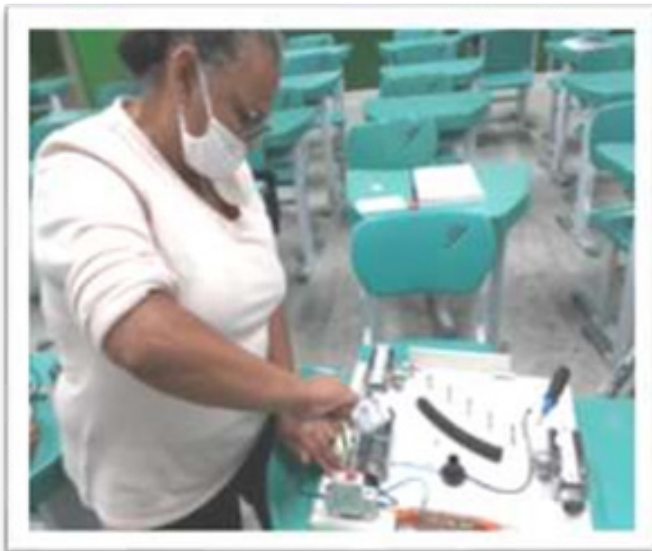
EDUCANDOS REALIZANDO A MONTAGEM DO PAINEL PARA ACENDIMENTO DE LÂMPADA COM INTERRUPTOR PARALELO
